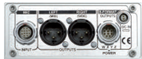
Anschlüsse, Einstellungen, Pegelung: Die Kontrolleinheit.
