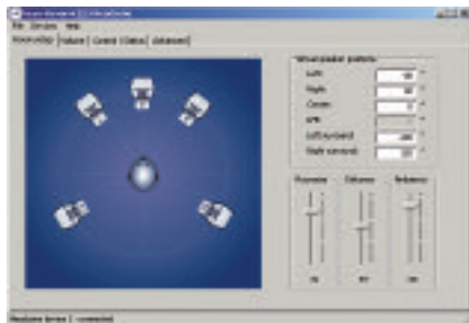
Das „Room Setup“ in der Software zum Headzone: hier lassen sich die virtuellen Lautsprecher beliebig verschieben und im Raum anordnen.
